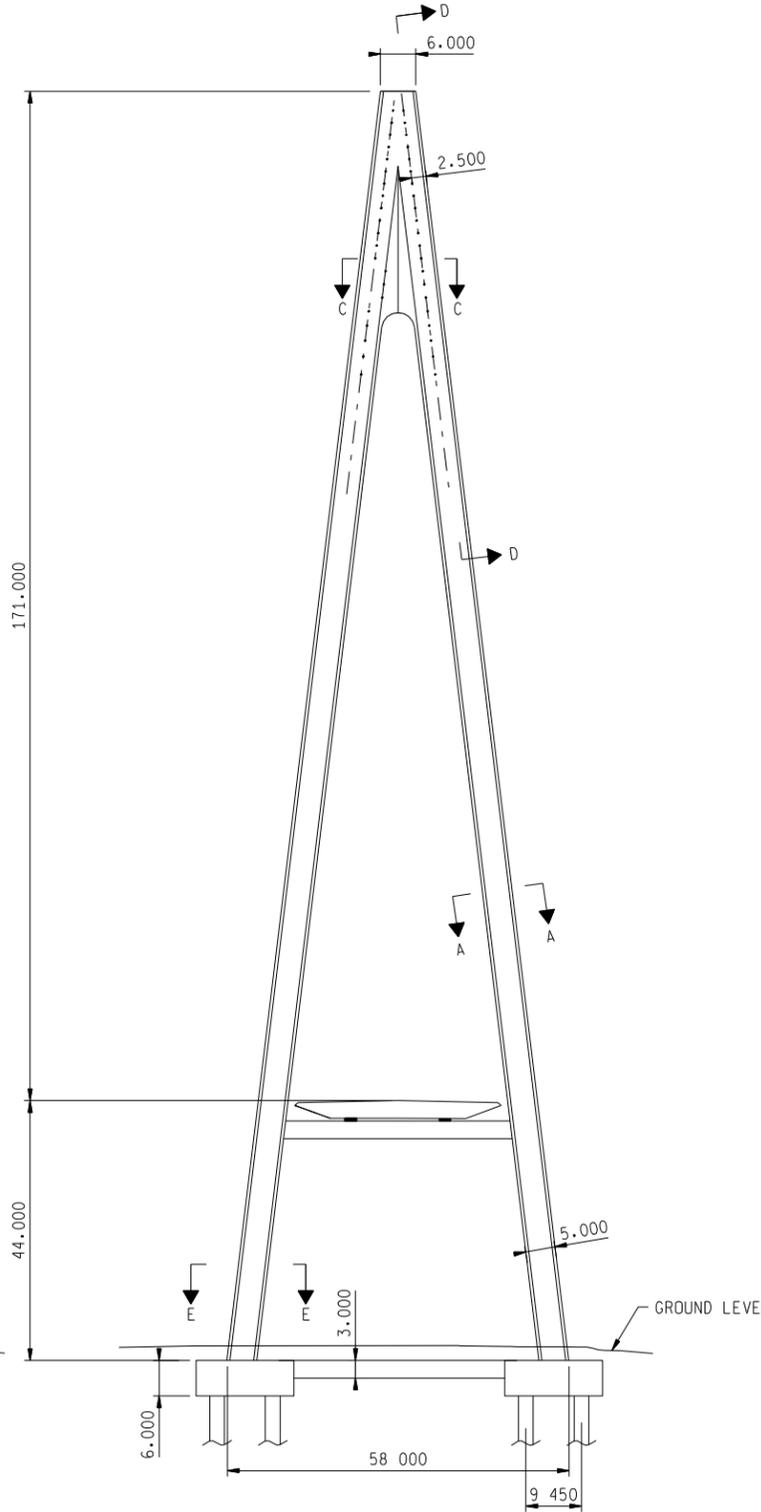
A-SHAPE PYLON ELEVATION
