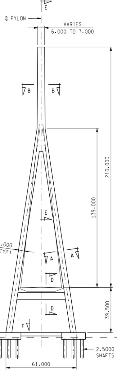
Y - SHAPE PYLON ELEVATION
