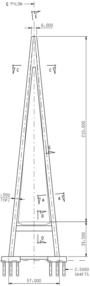
A - SHAPE PYLON ELEVATION
